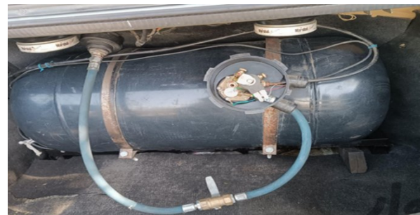
شکل ۲) مخزن ال‌پی‌جی با شلنگ‌های انتقال سوخت در خودروی پژو ۱۴۰۵
