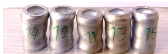
شکل (۱۰) تغییر شکل هسته‌های سازه پس از بارگذاری
