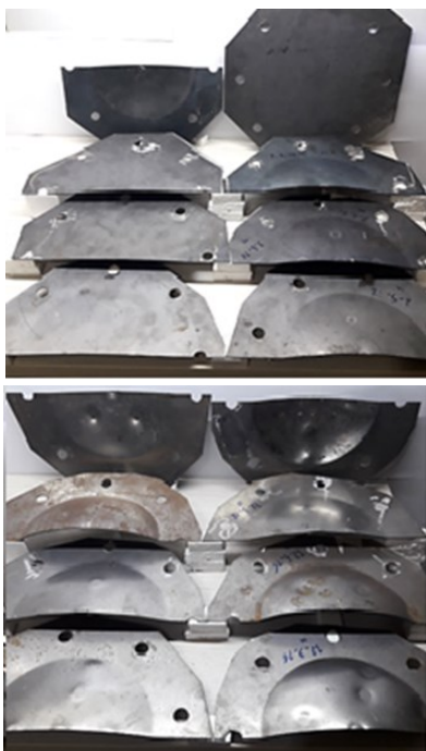
شکل ۳) رویه‌های فوقانی و تحتانی متناظر در سازه‌های تجربی-ورق ۲ میلیمتر (بالا) ورق ۱/۲ میلیمتر (پایین)
