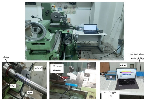
شکل ۳) تصاویر دستگاه تراشکاری مورد استفاده، تجهیزات اندازه‌گیری نیروی سه بعدی نیرو و نمونه قطعه‌کار در حال روتراشی
