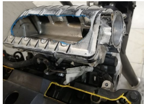
شکل (۳) مدل برش خرده منیفولد موتور EC5 که حجم مشدد در پشت آن با دو مجرا به آن اتصال دارد.
