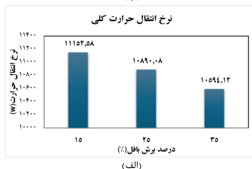
شکل ۸) نمودار نرخ انتقال حرارت کلی، الف) بافل کات‌های ۱۵، ۲۵ و ۳۵ درصد ب) زاویه بافل‌های ۰، ۱۵ و ۳۰ درجه
