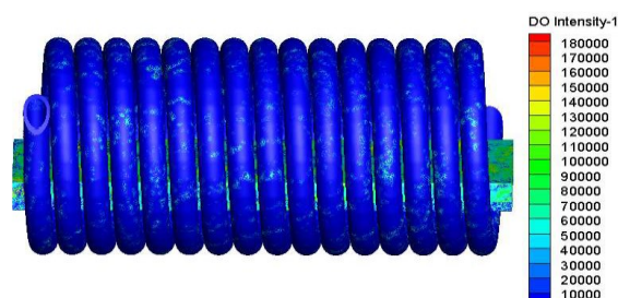
شکل ۱۶) کانتور شدت تشعشع بر روی لوله‌ی مارپیچ و سرباره
