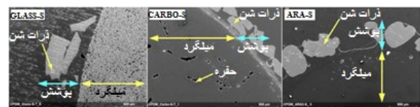
شکل ۳) تصاویر میکروسکوپ الکترونی روبشی (SEM) از مقاطع صیقلی با بزرگنمایی کم، برای سری‌های مختلف میلگردهای FRP با پوشش شنی
