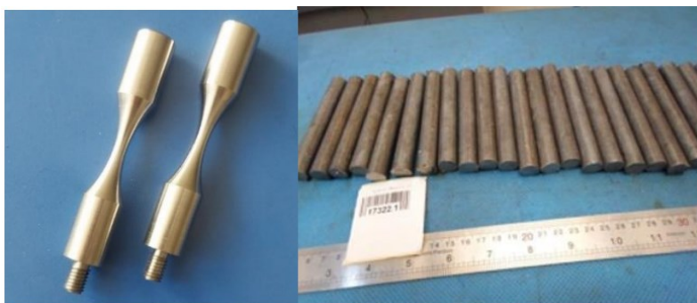
شکل ۷) نمونه‌های آزمایش خستگی فراصوت قبل و بعد از فرایند ماشین‌کاری
