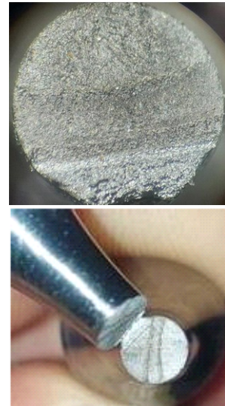
شکل ۱۱) تصویر شکست نمونه در محدوده تنش ۴۰۰ مگاپاسکال
