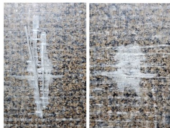
شکل ۹) نمونه LSPC1 تحت برخورد پرتابه با سرعت ۱۵۸ متر بر ثانیه. الف) جلو نمونه. ب) پشت نمونه.
