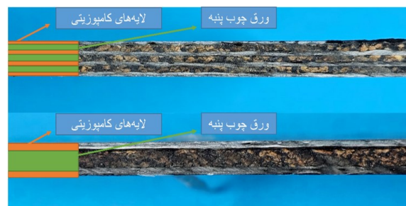
شکل ۲) سطح مقطع و نوع ساختار نمونه های ساندویچی
