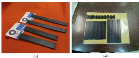
شکل ۶) نمونه‌های پرینت شده، (الف) نمونه ABS خالص، (ب) نمونه کامپوزیتی
