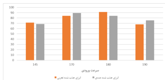
شکل ۱۰) انرژی جذب شده تجربی و عددی سازه در سرعت های ورودی مختلف
