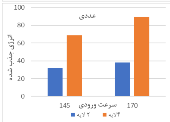
شکل ۷) انرژی جذب شده تجربی و عددی سازه های دو و چهار لایه
