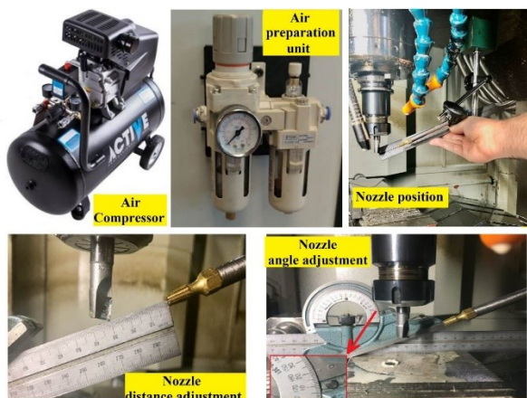
شکل ۲ نمایش اجزای اصلی مدار MQL در تست‌های فرزکاری
