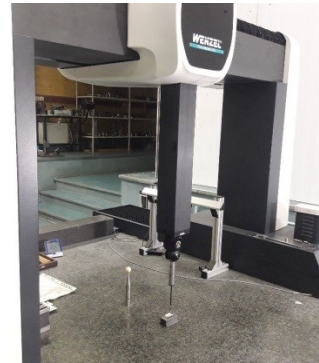
شکل ۹ اندازه گیری ابعاد هندسی هسته برش خورده پس از تغییر شکل توسط دستگاه CMM
