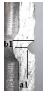
شکل ۱۰-الف بخشی از مقطع هندسی هسته شیاردار در فرآیند تغییر شکل
