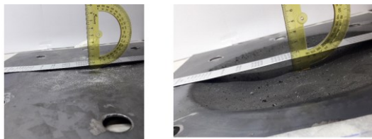
شکل ۶ جابجایی عرضی ورق‌های فوقانی و تحتانی سازه آزمایش (۲) راست به چپ
