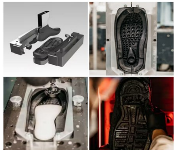
شکل ۱ ساخت قالب تزریق مستقیم زیره کفش توسط شرکت ecco [10] Fig. 1 Making direct injection molds for shoe soles by ecco [10]
