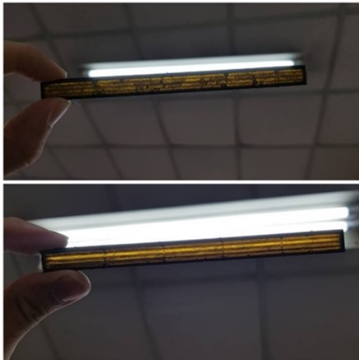
شکل ۸ تاثیر پیش گرم شدن رزین اپوکسی در مقدار ایجاد حباب در نمونه‌ها Fig. 8 Effect of pre-heating epoxy resin on bubble formation in the samples
