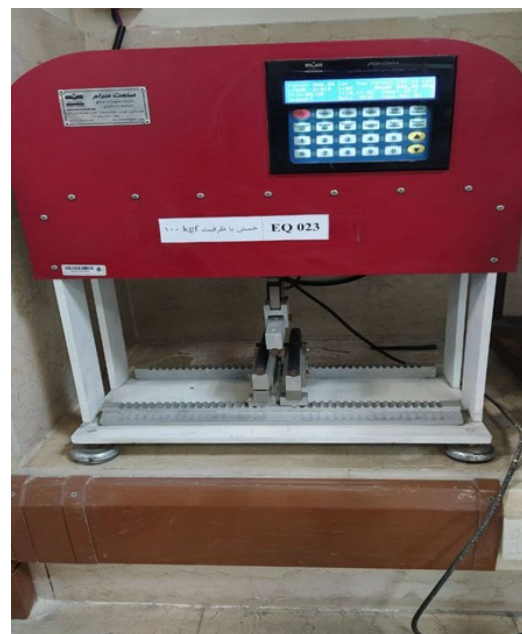
شکل ۹ انجام تست خمش سه نقطه بر روی نمونه های ۱ میلی متری Fig. 9 Conducting three-point bending test on 1-mm-thick samples
