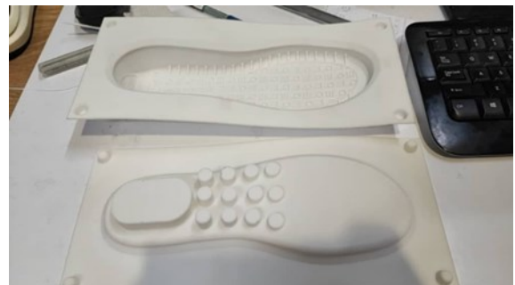
شکل ۲ قالب اولیه ساخته شده به طور ساده و دارای استحکام پایین Fig. 2 The initial mold is simply made and has low strength
