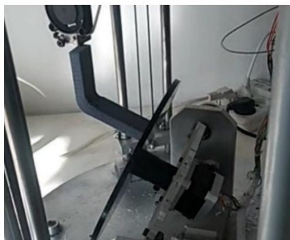
شکل ۱۴ مراحل حین فرآیند چاپ پنج محور نمونه بدون تکیه‌گاه
