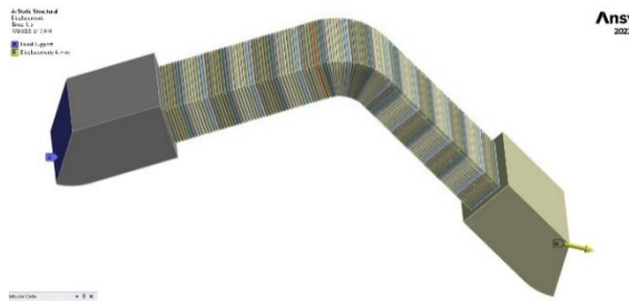
شکل ۷ شرایط اولیه در قطعه (بدون تکیه‌گاه-پنج‌محور) در آزمایش کشش
