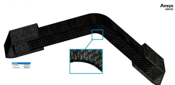
شکل ۶ تصویر مش‌بندی در قطعه (بدون تکیه‌گاه-پنج‌محور) در آزمایش کشش
