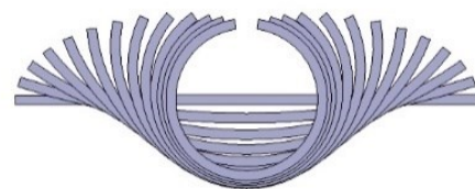
شکل ۹: الگوی گل طراحی شده برای فرایند شکل‌دهی غلتکی سرد لوله Fig 10. Flower pattern designed for the cold roll forming process of pipe
