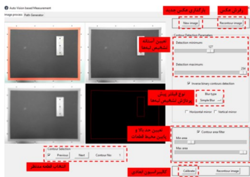
شکل ۱۶ صفحه‌ی رابط کاربری نرم افزار به منظور پردازش تصویر و تشخیص قطعات به همراه تنظیمات مربوطه
