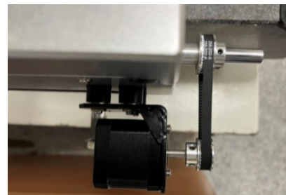
شکل ۷ نحوه اتصال استپرموتور بر روی محور Y
