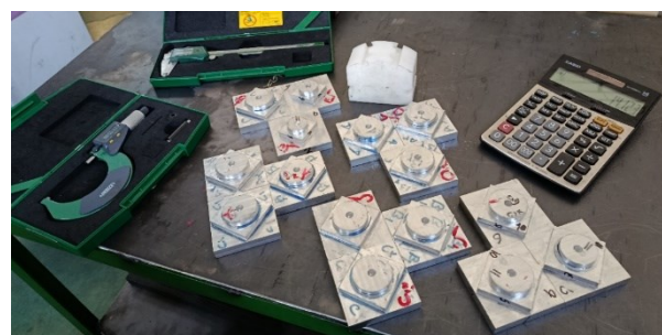
شکل ۱۲ قطعات ماشینکاری شده نس در مرحله اندازه گیری
