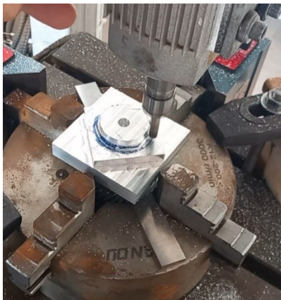
شکل ۹ ماشینکاری قطعه نس مطابق جی‌کدهای بدست آمده
