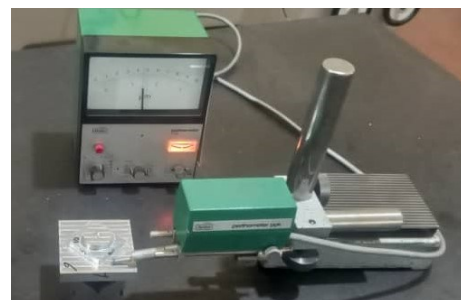
شکل ۱۱ اندازه گیری صافی سطح قطعه نس
