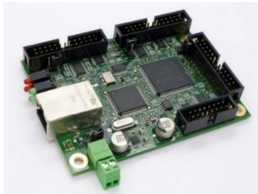
شکل ۲ بُرد کنترلی حرکتی مورد استفاده در ربات ماشین ابزار Fig. 2 Motion control board used in machine tool
