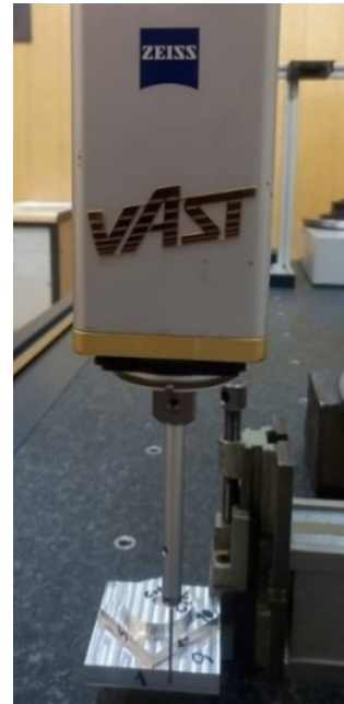
شکل ۱۰ اندازه گیری قطعه نس با دستگاه مختصات سه بعدی (CMM)
