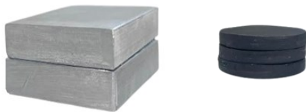
شکل ۵ هندسه اتصال یافته (الف) ۳ قطعه گرافیت (ب) ۲ قطعه آلومینیوم ۶۰۶۳
