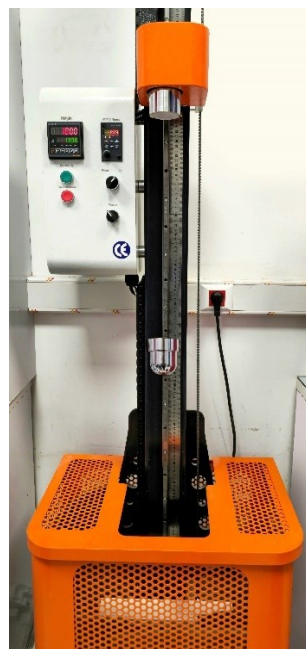
شکل ۸ نحوه انجام آزمون ضربه سقوط آزاد جسم Fig. 8 The procedure of falling weight impact test
