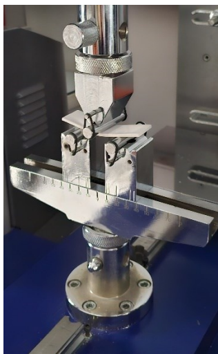
شکل ۱ نحوه انجام آزمون خمش سه نقطه‌ای
