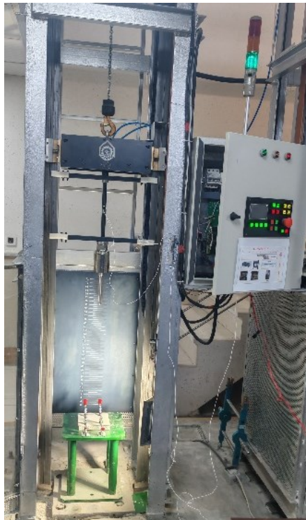
شکل ۸ دستگاه آزمون نفوذ (Drop-weight impact)
