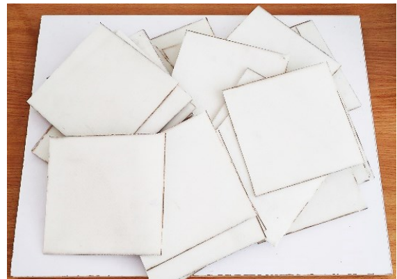
شکل ۱ نمونه‌های پنل ساندویچی GFRP پس از برش به ابعاد ۱۵۰ × ۱۵۰ میلی‌متر
