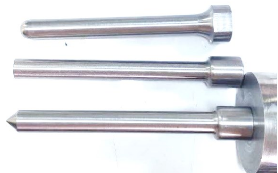
شکل ۷ نفوذگرها با هندسه نوک تخت، نیم کروی و مخروطی
