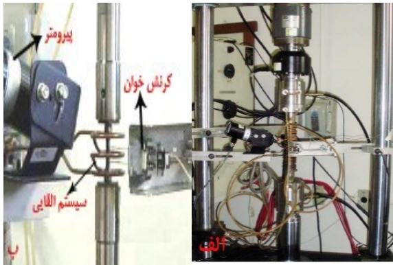
شکل ۳ الف- دستگاه تست خستگی و ب- سیستم القایی، کرنش خوان و پیرومتر
