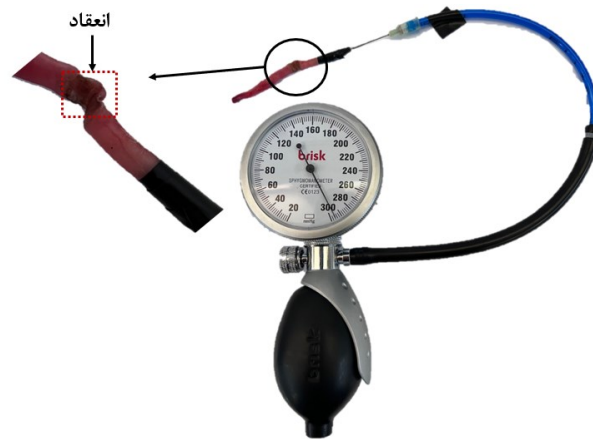
شکل ۴) چیدمان اندازه‌گیری میزان تحمل فشار رگ بسته شده
