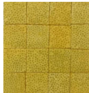
شکل ۳ لایه عایق ساخته شده با فوم حبابدار با ابعاد ۳۲×۳۲ سانتی‌متر Fig. 3 Bubble foam insulation layer, 32×32 cm.
