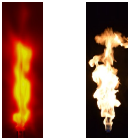
شکل ۹ کانتور تشعشع لحظه‌ای جریان گازهای حاصل از احتراق در فضای محاسباتی استوانه‌ای مشعل و تصویربرداری لحظه‌ای جریان گازهای حاصل از احتراق ناشی از تغییرات دبی جرمی هوای خروجی از نازل مرکزی مشعل [۴۱].
