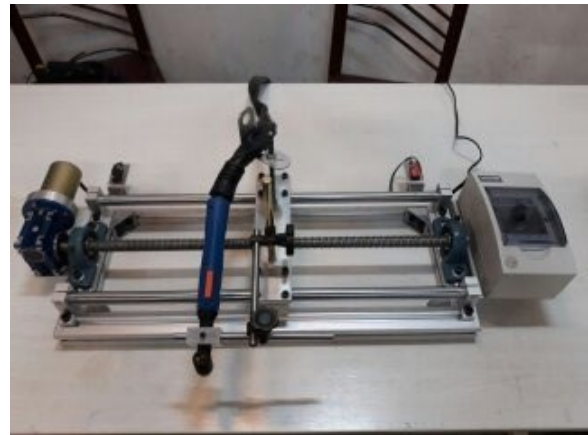
شکل ۱ دستگاه جوشکاری اتوماتیک مورد استفاده برای ایجاد خطوط جوش طولی در نمونه‌های آلومینیومی.
