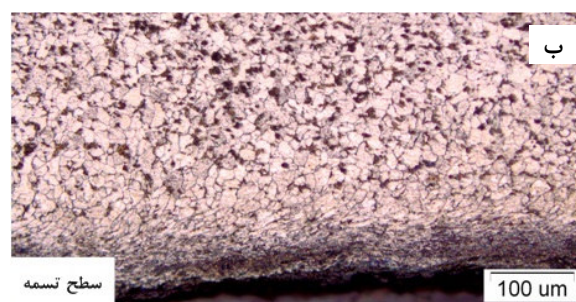
شکل ۱۳ آنالیز تصویری تسمه سری A با بزرگ‌نمایی ۲۰۰ برابر الف: قبل از عملیات شات‌پینینگ، ب: بعد از عملیات شات‌پینینگ
