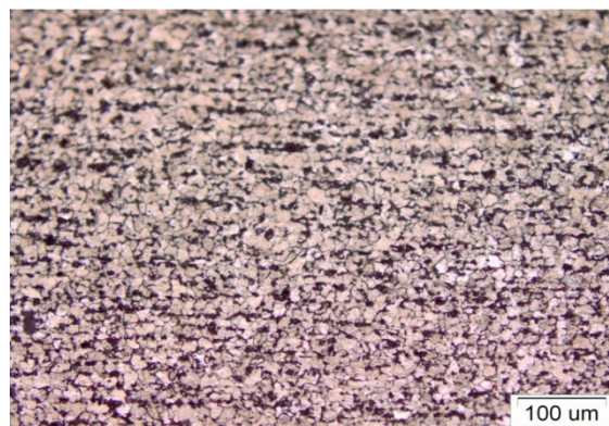
شکل ۴ آنالیز تصویری از سطح تسمه سری A با میکروسکوپ نوری با بزرگ‌نمایی ۲۰۰ برابر
