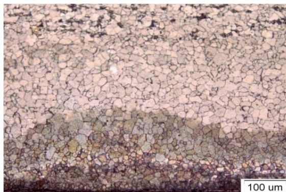
شکل ۵ آنالیز تصویری از سطح تسمه سری B با میکروسکوپ نوری با بزرگ‌نمایی ۲۰۰ برابر
