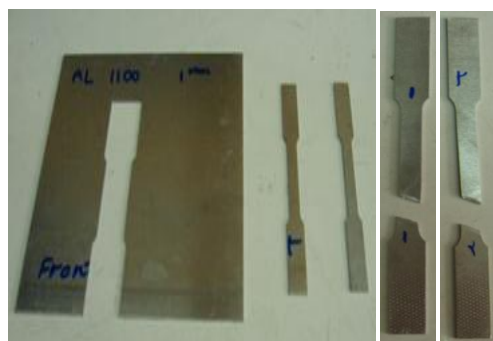
شکل ۳- نمایی از نمونه‌های تهیه شده از ورق آلومینیومی برای انجام آزمایش کشش قبل و بعد از آزمایش
