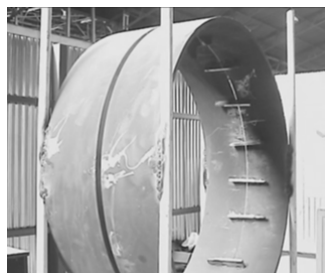
شکل ۲ الف- قید و بند لوله‌ها و تنظیم اتصال جوش محیطی
