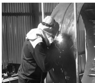
شکل ۲ ت- جوشکاری سر به سر لوله
