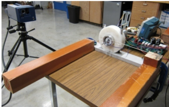
شکل ۱۵ دستگاه اندازه‌گیری جابجایی پیچشی بر حسب پیش تنش‌های پیچشی متغیر
