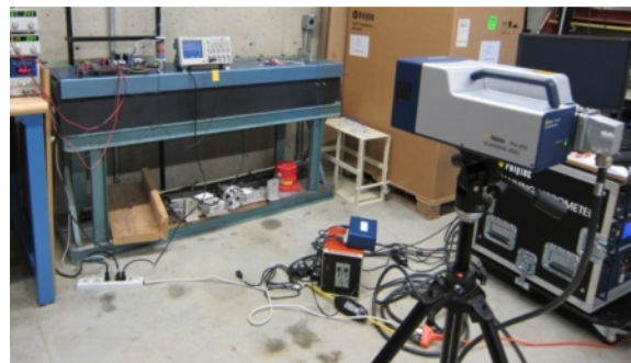
شکل ۱۰ دستگاه اندازه گیری جابجایی پیچشی ترانسدیوسر
