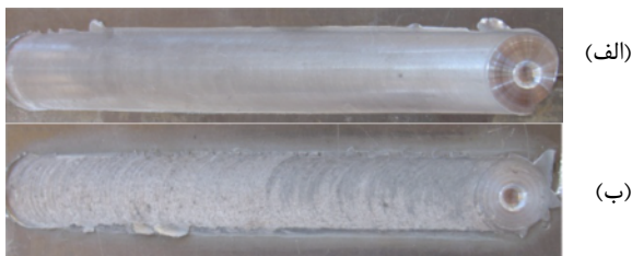
شکل ۵ تصویر سطح نمونه‌های جوشکاری شده به روش الف- FSW، ب- UFSW
