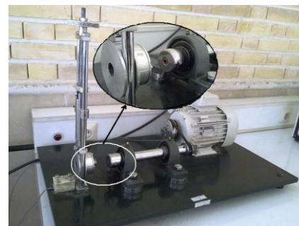
شکل ۲ دستگاه تست خستگی و فک‌های اتصال نمونه
