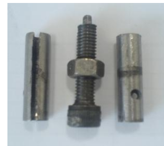
شکل ۳ بوش شیاردار جهت نصب نمونه‌ها در فک‌های دستگاه
