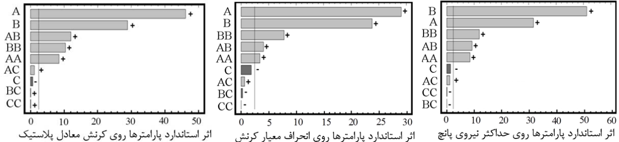
شکل ۸ میزان تأثیر متغیرهای طراحی روی توابع هدف (A: زاویه اکستروژن، B: ضریب اصطکاک و C: سرعت حرکت پانچ)
