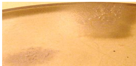
شکل ۱۱ نمونه‌ای از آسیب‌های سطحی پس از بازپخت
