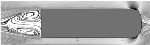
شکل ۸ نمایش بردار سرعت در نقاط مختلف بدنه
