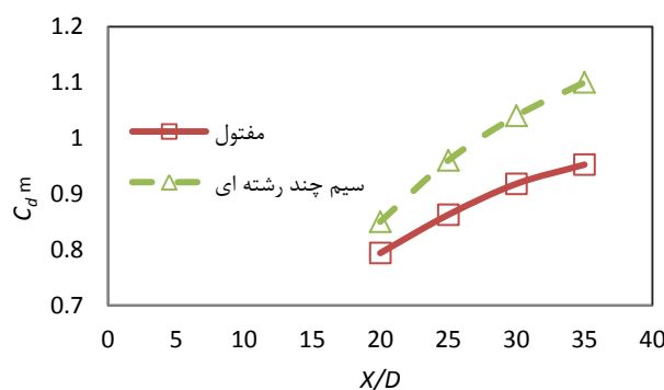
شکل ۸ توزیع ضریب نیروی پسا ناشی از اختلاف مومنتم بر حسب فاصله بی بعد شده در پایین دست مدل‌های مورد آزمایش برای عدد رینولدز ۱۵۷۰
