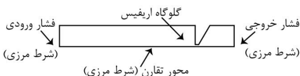
شکل ۸ مدل اریفیس به همراه شرایط مرزی به منظور استفاده در تحلیل CFD [۹]
