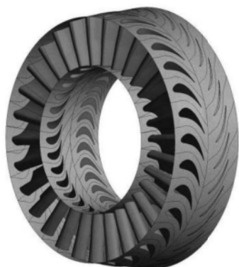
شکل ۵ هندسه سه بعدی توربین هانوفر
