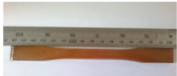
شکل ۱ نمونه آزمایش کشش
