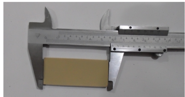
شکل ۲ نمونه آزمایش خمش
