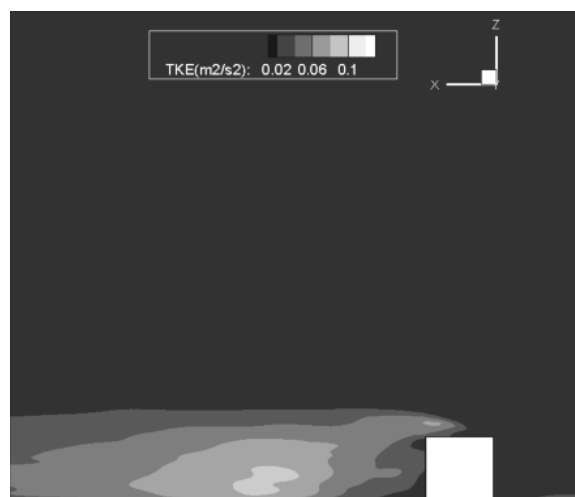
شکل ۱۹ مقدار انرژی توربولانسی در صفحه y = 5.5 با استفاده از مدل اسمآگورینسکی
