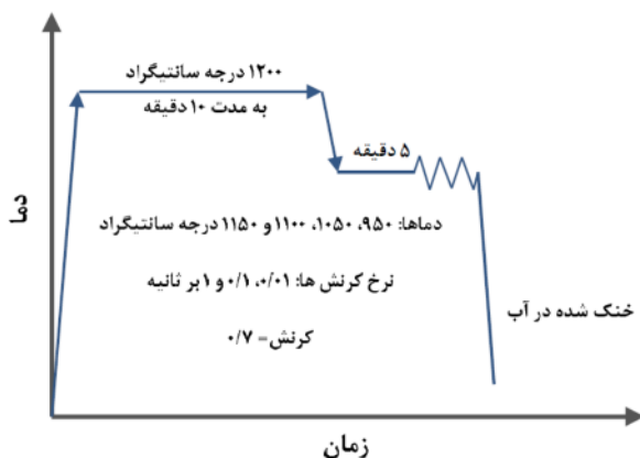
شکل ۱ جزئیات عملیات ترمودینامیکی اجرا شده در آزمون فشار گرم در تحقیق حاضر
