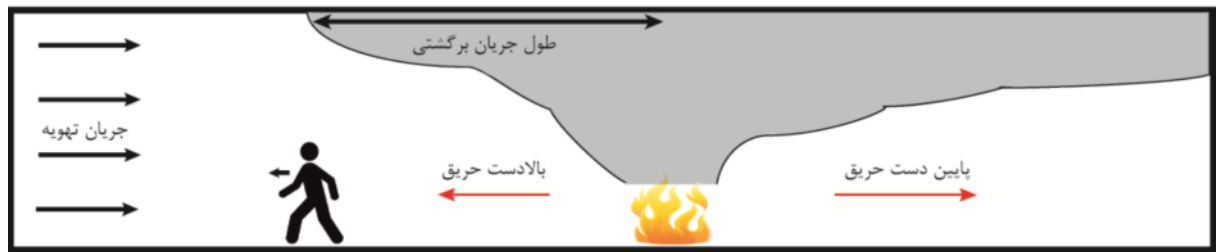
شکل ۱ طرح‌واره جریان حاصل از آتش‌سوزی در تونل تحت تهویه طولی
