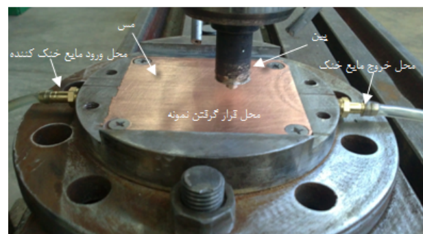
الف- قالب مورد استفاده برای خنک کاری
