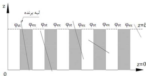
شکل ۳ محدوده انتگرال‌گیری در حالت‌های مختلف زاویه ورودی و خروجی ابزار [۱۳، ۱۴]
