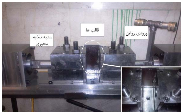
شکل ۵ شکل دستگاه بالچ آزاد لوله
