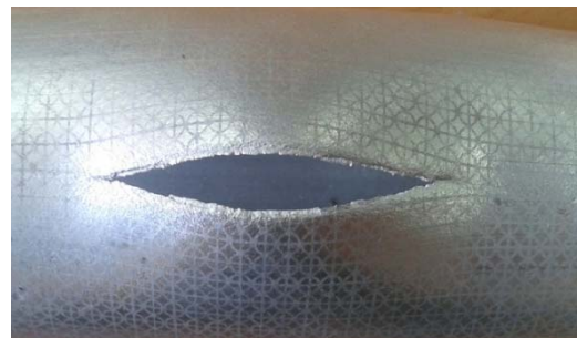
شکل ۱۰ دایره‌های حک شده بر روی لوله
