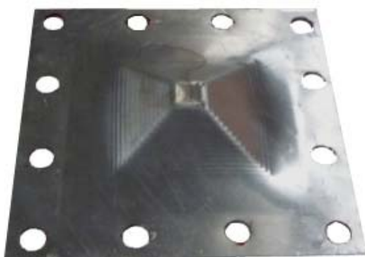
شکل ۱۱ قطعه به دست آمده در شرایط ضریب اصطکاک ۰/۰۵، قطر ابزار ۱۵ میلی‌متر و اندازه‌ی گام عمودی ۱/۵ میلی‌متر
