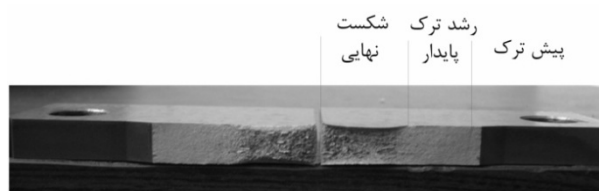
شکل 8 سطح شکست نمونه CT
