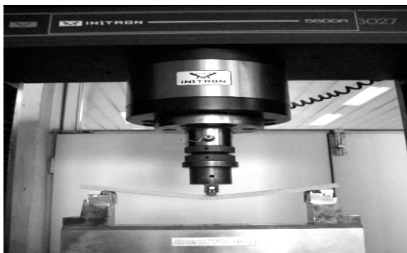
شکل ۳ آزمون خمش سه نقطه‌ای طبق استاندارد ASTM-C393
