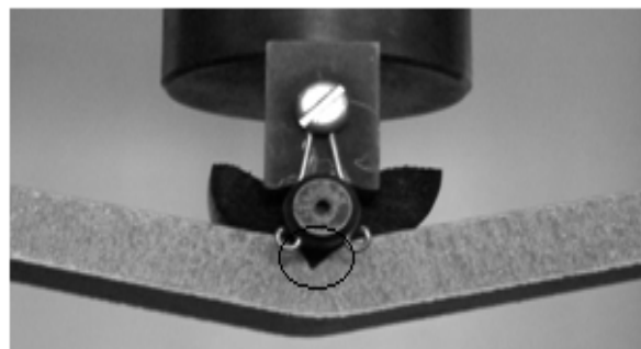
شکل ۷ شروع خرابی نمونه‌ی خمشی از رویه‌ی بالایی
