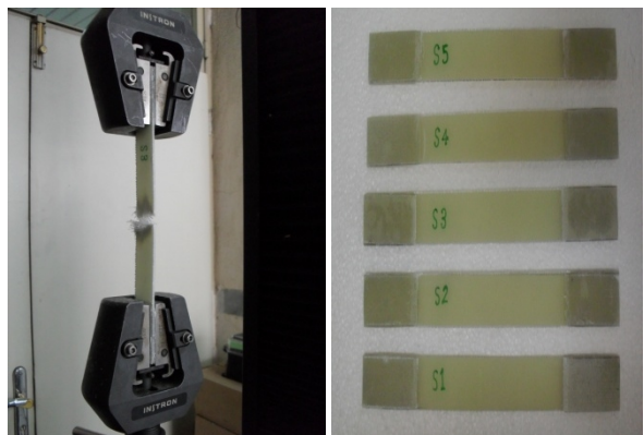
شکل ۴ (الف) آزمون کشش نمونه‌ی شماره ۳؛ (ب) نمونه‌های کشش
