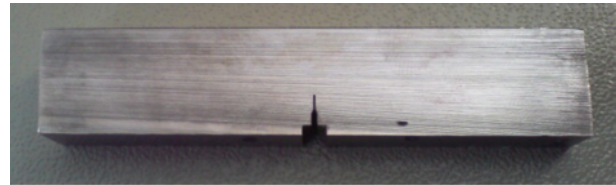
شکل ۹ نمونه ساخته شده برای اندازه گیری J_{Ic}
