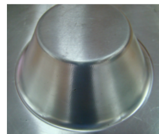
شکل ۷ فرم‌دهی ورق آلومینیومی به شکل مخروط
