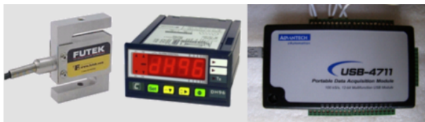
شکل ۸ (الف) کارت اکتساب داده - (ب) نمایشگر - (ج) لودسل
