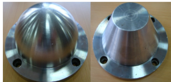
شکل ۲ سنبه‌های استفاده شده در فرآیند فرم‌دهی تدریجی دونقطه‌ای
